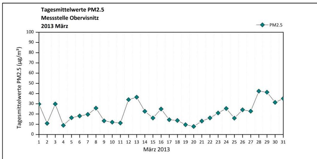
Abbildung 32: Messstelle S10 Obervisnitz – Messparameter Feinstaub PM<sub>2,5</sub>
