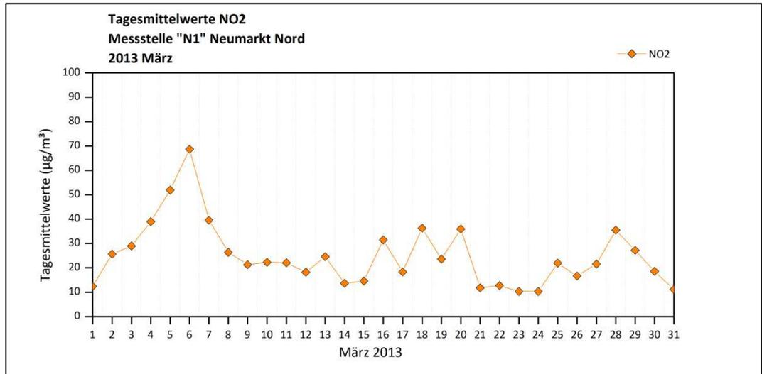
Abbildung 25: Messstelle S10 Neumarkt Nord – Messparameter Stickstoffdioxid NO<sub>2</sub> TMW
