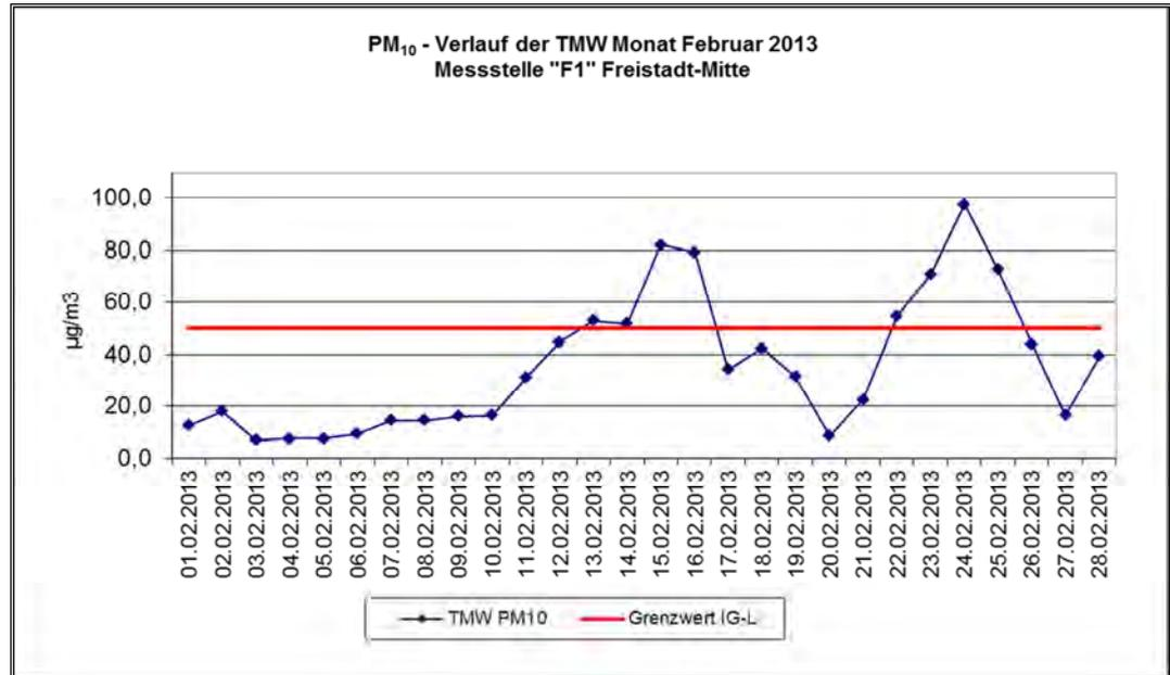
Abbildung 5: Messstelle S10 Freistadt Mitte – Messparameter Feinstaub PM<sub>10</sub>
