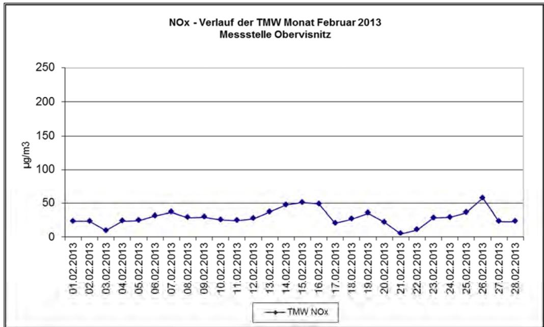
Abbildung 35: Messstelle S10 Obervisnitz – Messparameter Stickstoffdioxid NO<sub>x</sub>
